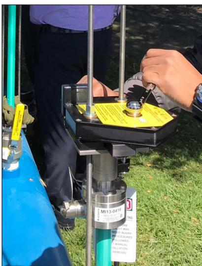
**Figura 21. Insertando el sensor con la herramienta de inserción**
