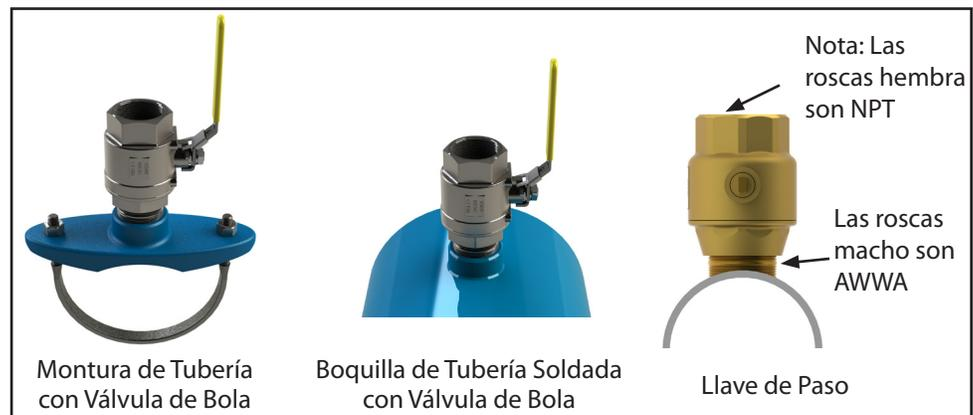
**Figura 11. Opciones de válvula de la instalación**
