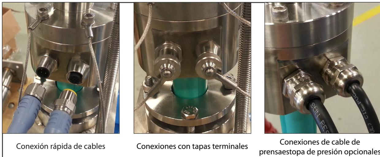
**Figura 6. Accesorios de conexión del sensor**
