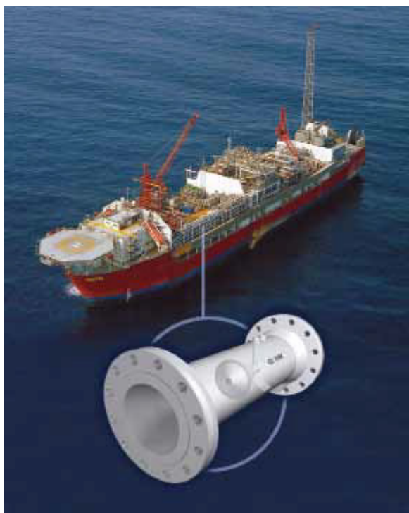
Figura 2: FPSO com medidor de vazão
