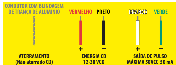
Figura 4. Diagrama de fiação
