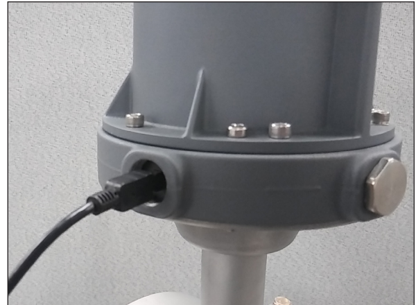
Figura 8. Conecte o cabo mini-USB
