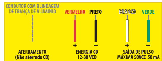
Figura 5. Diagrama de fiação
